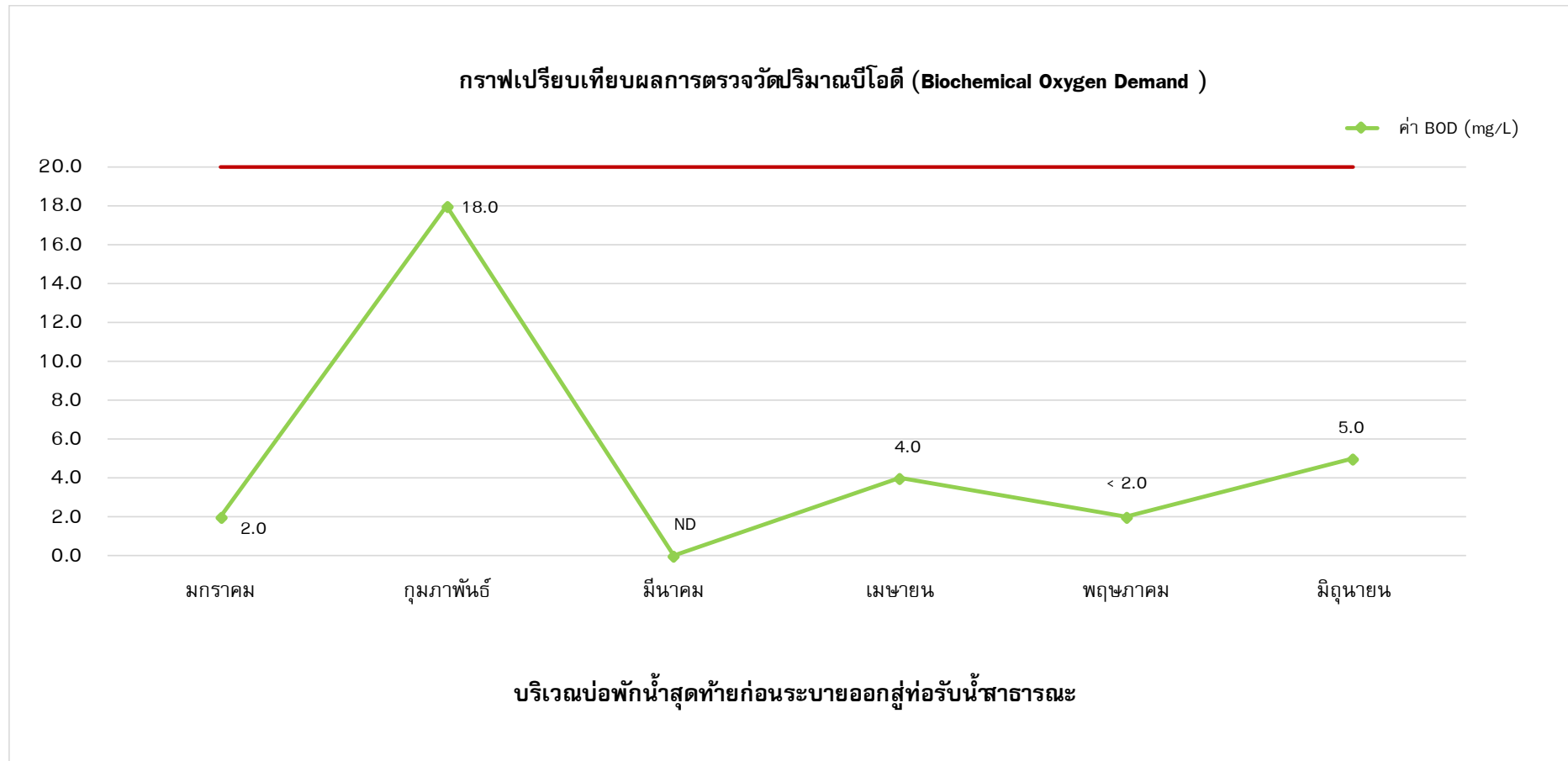
รูปที่ 4-18 กราฟเปรียบเทียบผลการตรวจวัดปริมาณบีโอดี (Biochemical Oxygen Demand)
